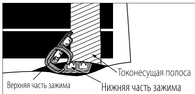
Нижняя часть зажима внутри медной токонесущей шины.
